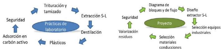
Figura 3 Relación de las prácticas de laboratorio con el proyecto de diseño
